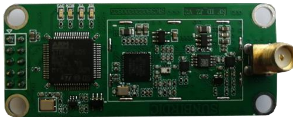
基站SOC模块：63X26X14mm（含天线座）
