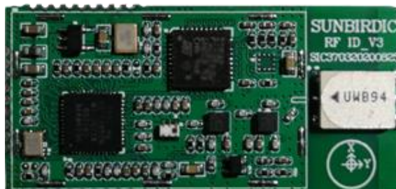
标签SOC模块：42X20X3mm
